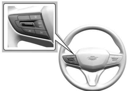
: Нажатие на эту клавишу включает и выключает систему круиз-контроля. При включении круиз-контроля в комбинации приборов загорается белый индикатор.
