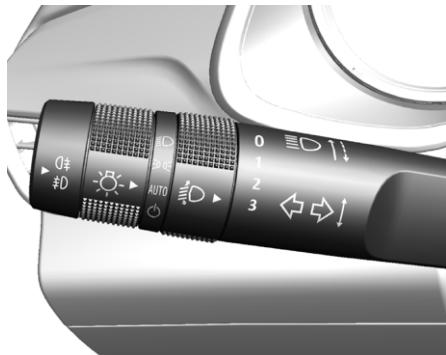
Для включения сигнала поворота полностью передвиньте рычаг вниз или вверх.
