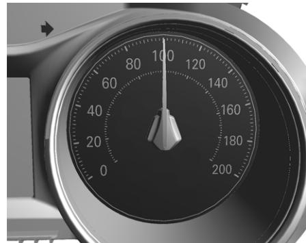
Спидометр показывает скорость движения автомобиля в километрах в час (км/ч).
