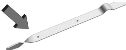
Если по результатам замера с ожиданием не менее 15 минут после выключения двигателя уровень масла ниже площадки с насечкой на конце щупа, долейте один литр рекомендованного масла и повторите проверку. См. далее в этом разделе пункт «Выбор надлежащего моторного масла», где поясняется, какой вид моторного масла следует использовать.
