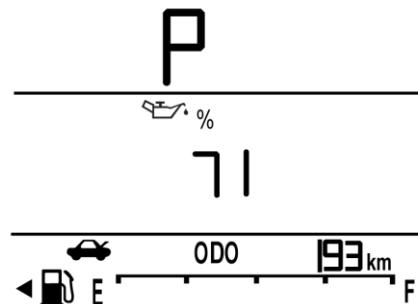
Отображается расчетный остаточный ресурс масла. Оставшийся ресурс масла указывается в процентах. Для сброса обратитесь к пункту «Сброс системы контроля срока службы моторного масла» в разделе Система контроля срока службы моторного масла ↴ 9-9.
