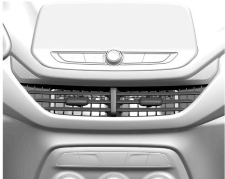
Отрегулируйте положение заслонок сопел вентиляции ползунком, чтобы изменить направление воздушных потоков.
