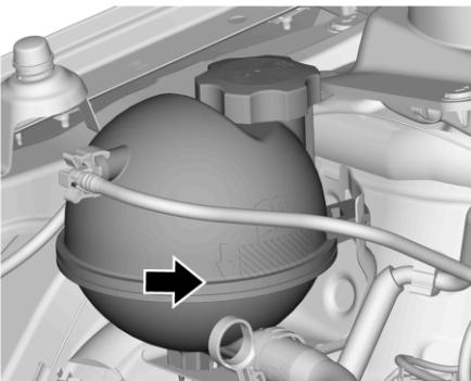
Расширительный бачок охлаждающей жидкости находится в моторном отсеке автомобиля, на стороне пассажира. См. Общий вид моторного отсека (Двигатель 1,2 л с турбонаддувом)  $\diamond$  9-6 или Общий вид моторного отсека (Двигатель объемом 1,2 л)  $\diamond$  9-7.
