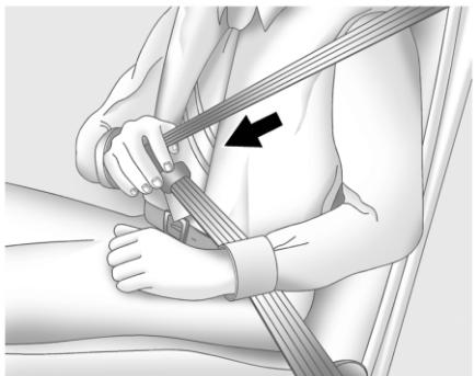
2. Потяните язычок защёлки и вытяните ремень на себя. Не допускайте перекручивания ремня.
