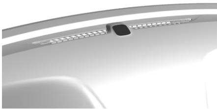
На верхней части панели приборов установлен датчик освещенности. Не закрывайте датчик.
