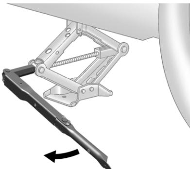
Поднимите автомобиль, вращая ручку домкрата по часовой стрелке. Поднимайте автомобиль, пока колесо не оторвётся от земли.
