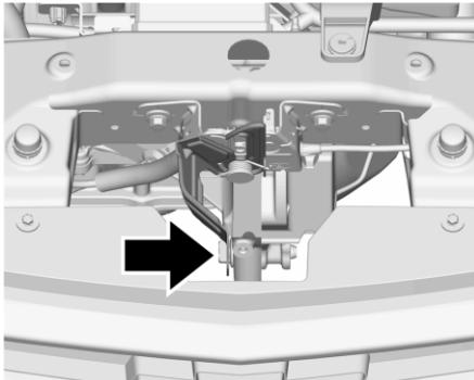
Сдвиньте лапку предохранительного крючка
