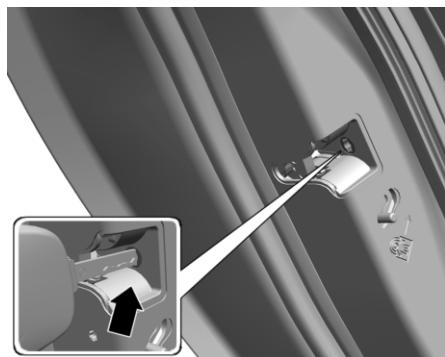
После этого дверь уже нельзя отпереть с помощью штифта, а только ручкой изнутри. Порядок блокировки или разблокировки замков дверей изнутри:
