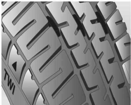
Кроме того, подлежат замене шины с протектором, изношенным до индикаторов допустимого износа. На иллюстрации показано, где можно определить глубину протектора.
