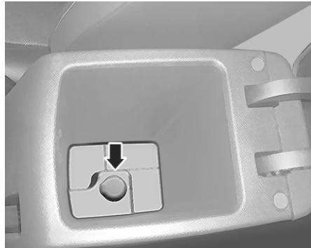
Розетки предназначены для электропитания такого вспомогательного электрооборудования, как мобильные телефоны, зарядные устройства GPS и любые другие электроприборы на 12 В, мощность которых не превышает 120 Вт.
