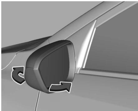
Для обеспечения безопасности пешеходов внешние зеркала складываются от удара определенной силы. Чтобы вернуть зеркало в рабочее положение, нужно слегка надавить на его корпус. Эта функция также полезна тем, что уменьшает полную ширину автомобиля, снижая вероятность повреждений при парковке.
