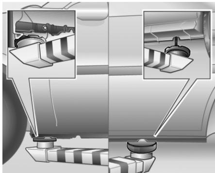
Опоры подъемника или домкраты должны устанавливаться в местах, показанных на иллюстрациях для передней и задней части автомобиля, между точками и поддомкрачивания и колесными нишами.
