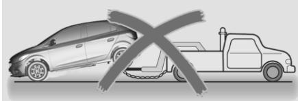
Буксировка данного автомобиля с двумя колесами на дороге не допускается.
