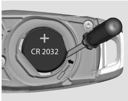
2. Извлеките элемент питания с помощью небольшой отвертки, поддев его в указанном на рисунке месте.
