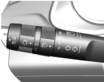
Переключатель освещения находится на рычаге переключения указателей поворота. Переключатель может быть установлен в одно из следующих положений:
