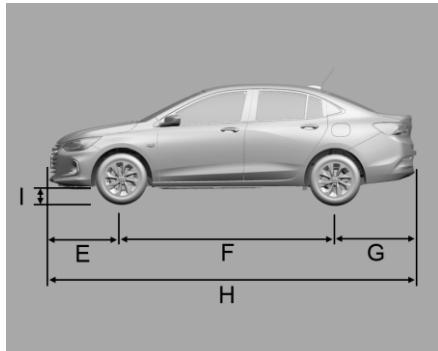
E. Расстояние от центров передних колес до переднего бампера - 882 мм
