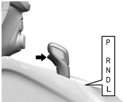
**P :** В этом положении блокируются ведущие колеса. Устанавливайте селектор в положение Р (Парковка) при запуске двигателя, т.к. в этом случае автомобиль не сможет случайно тронуться.
