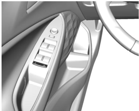
Для блокировки выключатель стеклоподъемников на задних дверях можно воспользоваться выключателем . При повторном нажатии выключателя блокировка отключится.
