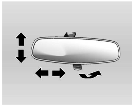
Зеркало можно отрегулировать, наклонив его в удобное положение.
