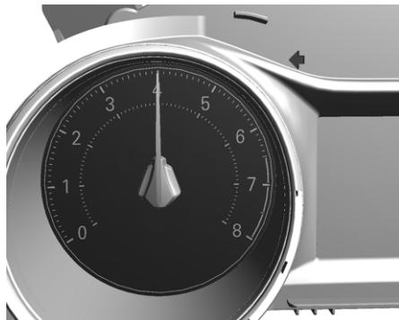
На тахометре отображается число оборотов двигателя в минуту (об/мин).
