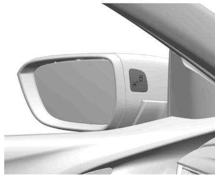
Система предупреждения о препятствиях в боковых мертвых зонах активируется, когда скорость автомобиля превышает 10 км/ч. Если скорость автомобиля превышает 140 км/ч, система выключается, и яркость свечения индикаторов в левом и правом наружных зеркалах заднего вида снижается; если затем скорость автомобиля уменьшится, индикаторы в зеркалах гаснут. Если после этого в мертвой зоне будет обнаружен автомобиль, индикатор в соответствующем зеркале заднего вида загорается.
