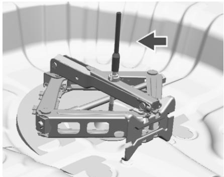
4. Прежде чем укладывать поврежденное полноразмерное колесо в нишу для запасного колеса, установите удлинительный болт.
