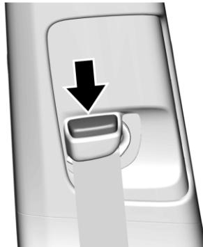
Нажав на кнопку разблокировки, переведите регулятор высоты в нужное положение. Чтобы переместить верхнюю точку крепления ремня вверх, достаточно сдвинуть вверх декоративную накладку.
