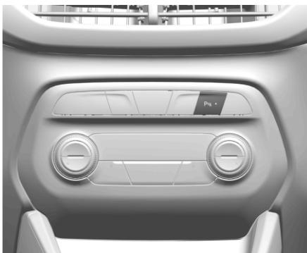
Кнопка **P**, если имеется, позволяет одновременно включить или выключить системы помощи при парковке передним и задним ходом. Индикатор, расположенный рядом с кнопкой, загорается при включении функций и гаснет, когда функции выключены.
