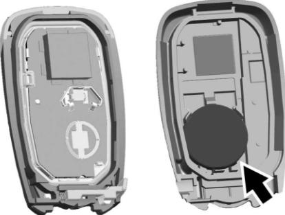
2. Разделите корпус радиобрелока на две половины, вставив плоский инструмент в область рядом с гнездом для ключа.
