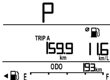
Счетчик текущего пробега показывает расстояние, пройденное автомобилем после последнего сброса показаний счетчика. На дисплее также отображается среднее значение расхода топлива. Для сброса показаний откройте соответствующую страницу и несколько секунд удерживайте нажатой кнопку SET/CLR.
