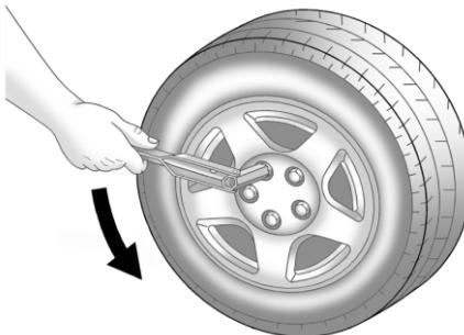
Установить колесный ключ так, чтобы он был надежно надет на гайку, слегка отвернуть каждую колесную гайку на пол-оборота.
