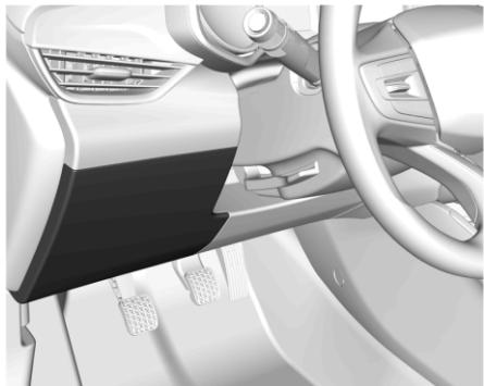
Установленный в панели приборов блок предохранителей расположен снизу со стороны водителя.
