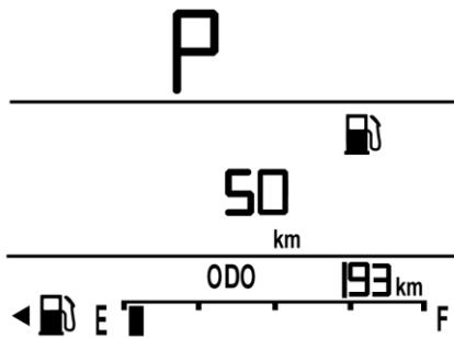
Запас хода рассчитывается на основе текущего остатка топлива в баке и текущего расхода. На дисплей выводится усредненное значение. Спустя некоторое время после заправки данные по запасу хода автоматически обновятся.
