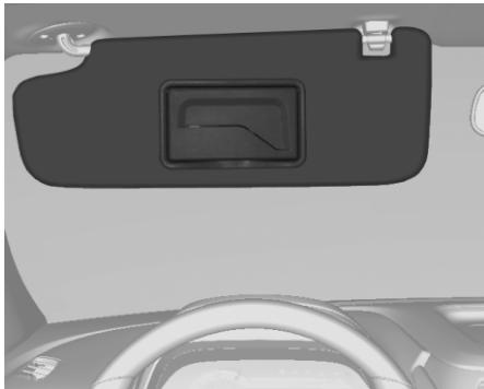
Солнцезащитные козырьки могут складываться или отворачиваться в сторону во избежание ослепления ярким светом. В обоих солнцезащитных козырьках имеются зеркала. Во время движения зеркало в солнцезащитном козырьке водителя должно быть закрыто.
