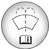
Откройте крышку с расположенным на ней символом омывателя. Доливайте жидкость для омывателя, пока бачок не будет заполнен. Местоположение бачка см. в разделе Общий вид моторного отсека (Двигатель 1,2 л с турбонаддувом) ▷ 9-6 или Общий вид моторного отсека (Двигатель объемом 1,2 л) ▷ 9-7.
