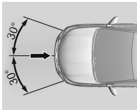
В случае удара определенной силы, приходящегося на указанную область, происходит срабатывание передних подушек безопасности. Зажигание должно быть включено.
