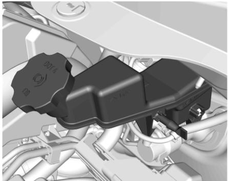
Уровень тормозной жидкости должен быть между отметками **MIN** и **MAX**.
