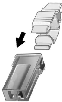
Съёмник устанавливают на предохранитель сверху или сбоку в зависимости от типа и вынимают предохранитель.
