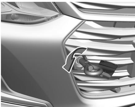
Заверните буксирную проушину до упора, остановив ее в горизонтальном положении. Буксирная проушина используется только для буксировки, а не для эвакуации автомобиля.
