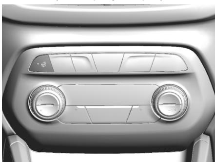
: Чтобы включить обогрев рулевого колеса, нажмите кнопку на блоке переключателей. После включения обогрева загорается индикатор. Чтобы выключить обогрев, снова нажмите кнопку.
