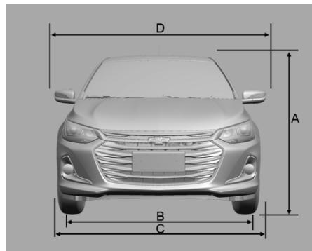
А. Полная высота до крыши - 1474 мм
