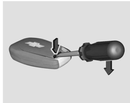
1. Вставьте в щель плоскую отвертку и снимите крышку корпуса радио-брелока.
