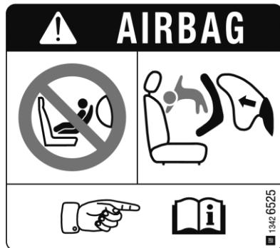
**КАТЕГОРИЧЕСКИ ЗАПРЕЩАЕТСЯ** устанавливать детское удерживающее устройство против направления движения на сиденье с АКТИВИЗИРОВАННОЙ ПОДУШКОЙ БЕЗОПАСНОСТИ передnim! Опасность ТЯЖЕЛОИ или СМЕРТЕЛЬНОЙ ТРАВМЫ РЕБЕНКА!
