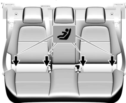
Ваш автомобиль оснащен крепежными скобами системы ISOFIX для установки детских удерживающих устройств.
