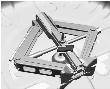
Отверните гайку-барашек против часовой стрелки.
