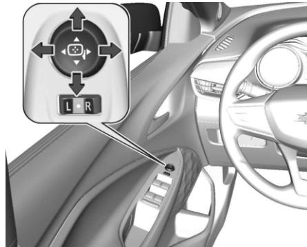
Органы управления зеркалами с электрической регулировкой располагаются на двери сбоку от водителя.
