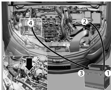
9. Подключите соединительные провода в следующем порядке:
