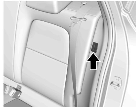
3. Вставьте язычок защелки ремня безопасности в место укладки.
