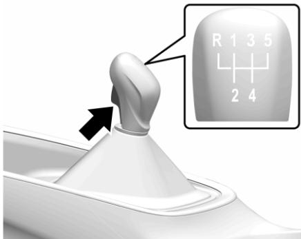
Положения рычага переключения передач:
